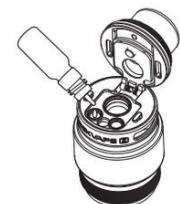
**Befüllen:** Die Nachfüllöffnung dieses Produktes ist kompatibel zu allen Nachfüllbehältern mit einem Ausgießer von maximal 3 mm. Füllen Sie das eLiquid aus dem Nachfüllbehälter durch die obere seitliche Öffnung bis maximal unter die obere Abdeckung in den Tank.
